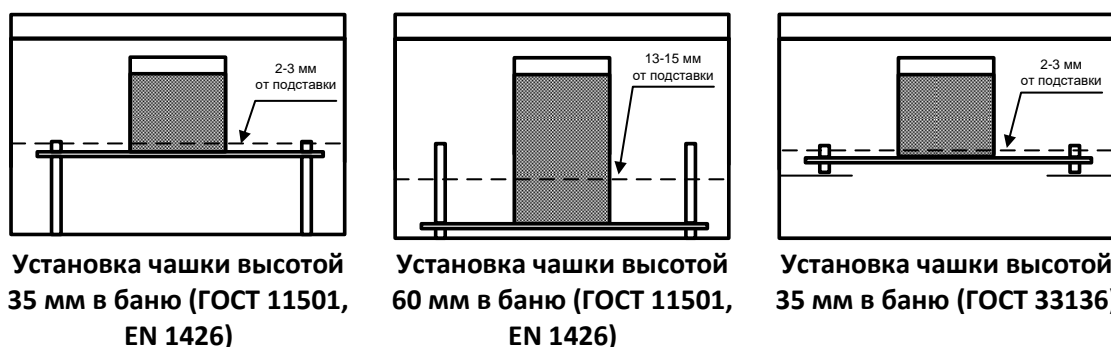
Рисунок 7 – Установка перфорированной подставки и термометра
