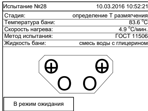
Рисунок 3 - Окно процесса испытания (нагрев с постоянной скоростью)
