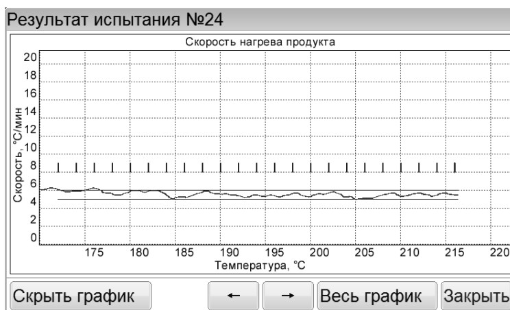
Рисунок 13 – Окно «Результат испытания»: график, зона поджига
