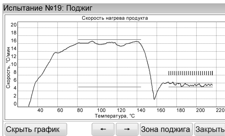
Рисунок 8 – Окно «Испытание»: график скорости нагрева продукта
